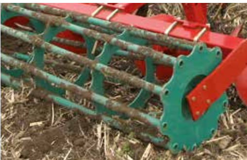
Cage roller Ø 550mm 90kg/m
